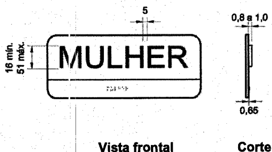
Figura 54 — Sinalização tátil – Exemplo
