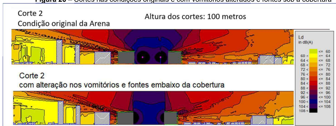
Figura 26 – Cortes nas condições originais e com vomitórios alterados e fontes sob a cobertura
