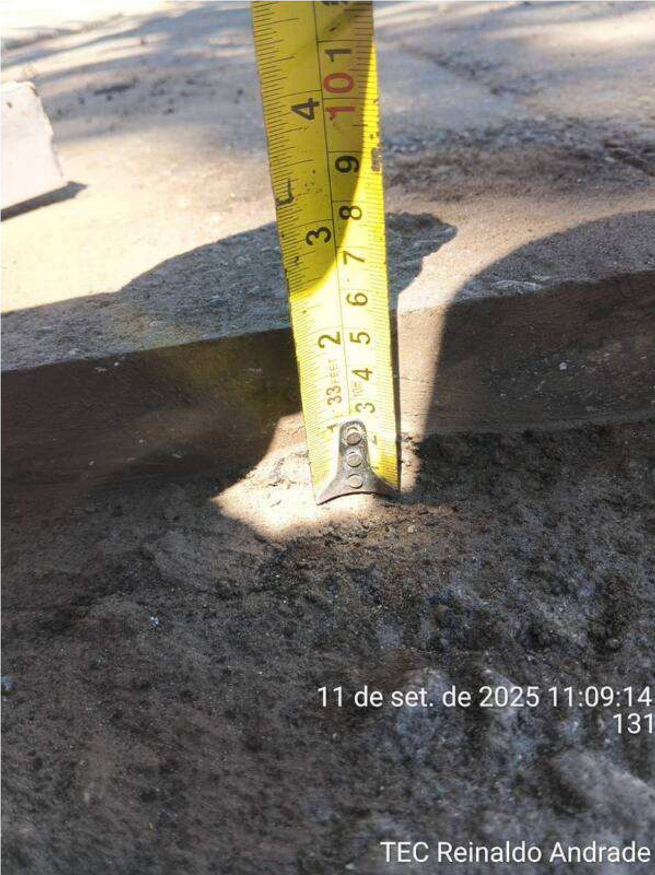
9 | PROFUNDIDADE → Registro da profundidade mais funda da caixa com uso da trena: Item de OS Origem: 13870897 - (Foto Capturada Em: 11/09/25 22:34, Por: mxintadm)
