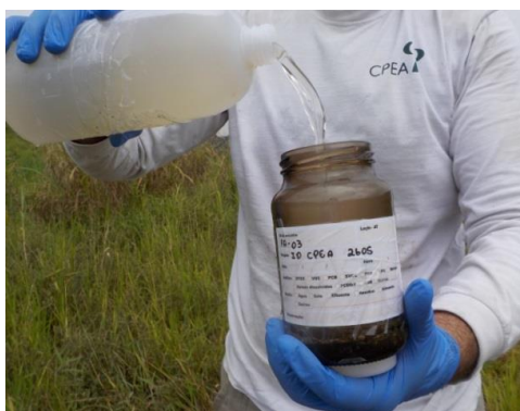
Transferência da amostra coletada para frasco apropriado com preservantes fornecido pelo laboratório responsável pelas análises químicas.
