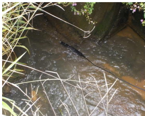
Realização das medições físico-químicas in situ utilizando sonda multiparâmetros da marca HANNA, modelo HI9829.
