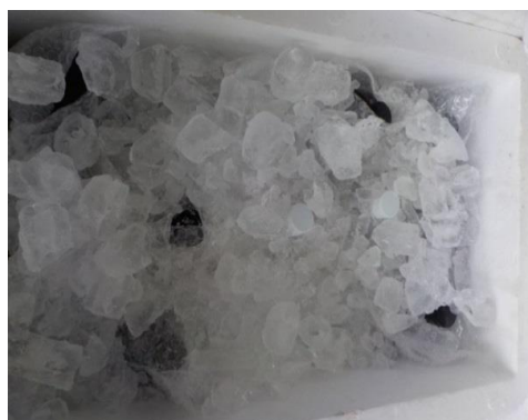
Amostras acondicionadas em caixas de térmicas com gelo, prontas para serem encaminhadas para o laboratório responsável pelas análises químicas.
