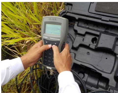
Registro das medições físico-químicas in situ utilizando sonda multiparâmetros da marca HANNA, modelo HI9829.
