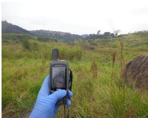
Georreferenciamento dos pontos de amostragem utilizando um receptor GPS.
