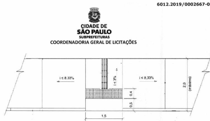
FIGURA 7 – Croqui rampa tipo B
