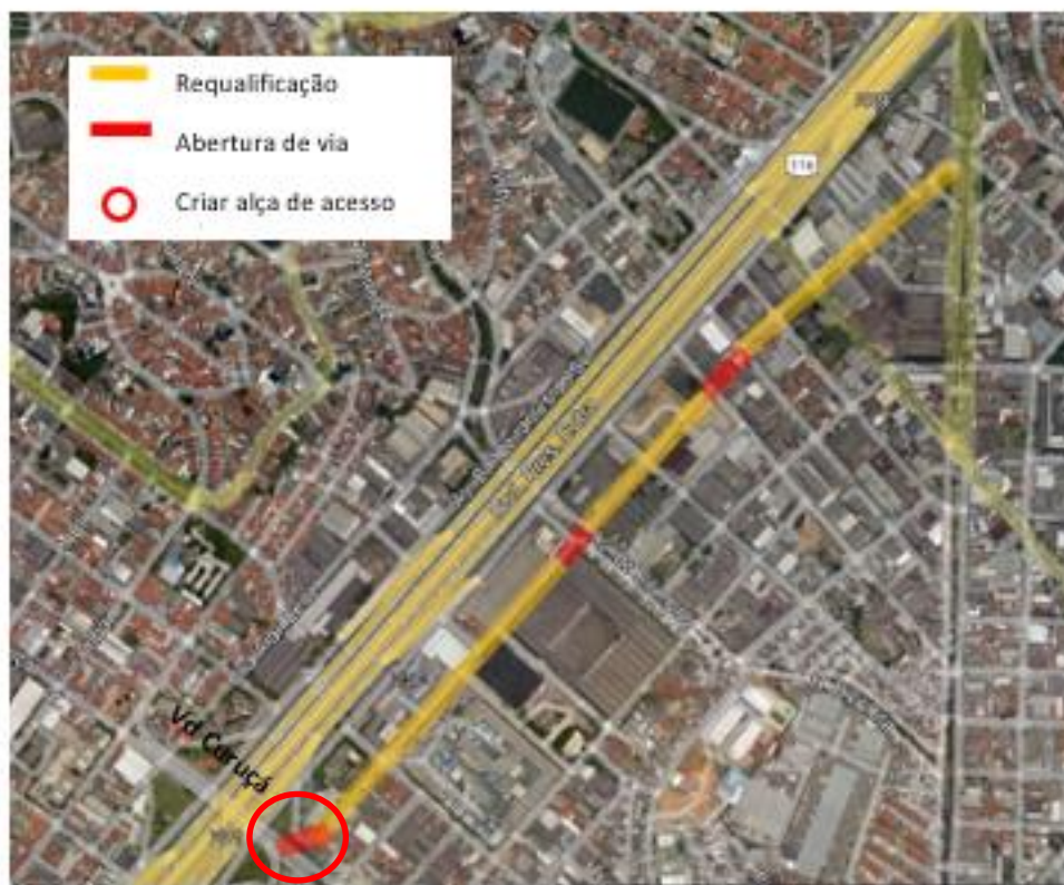
Figura 3 – Alternativa para tráfego de caminhões
