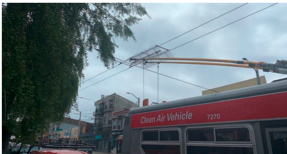
Painel de conexão automática das alavancas, sem a necessidade de manuseio externo pelo operador.
