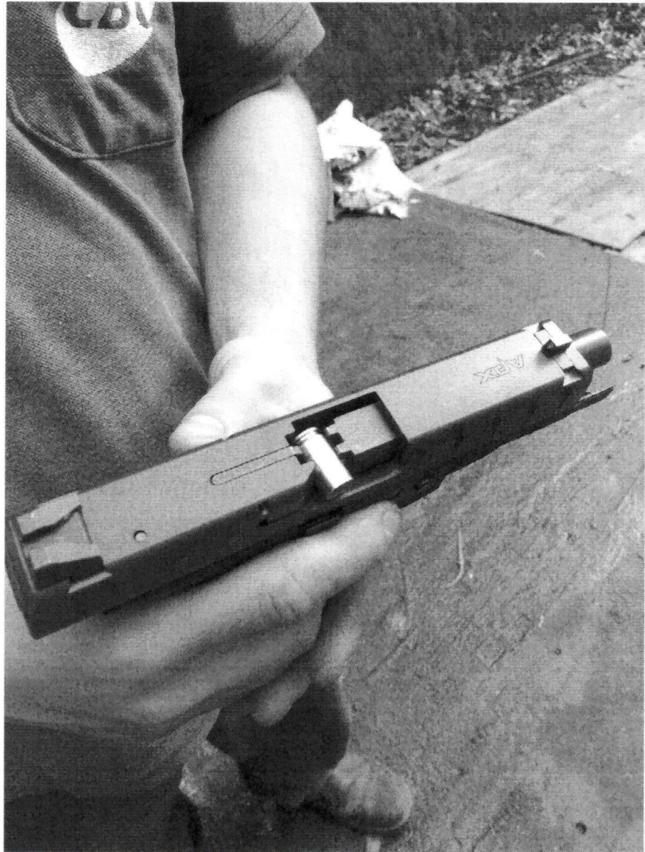
Imagem 6 – Exemplo falha de ejeção (9mm NTA 124gr carregado no limite mínimo).
