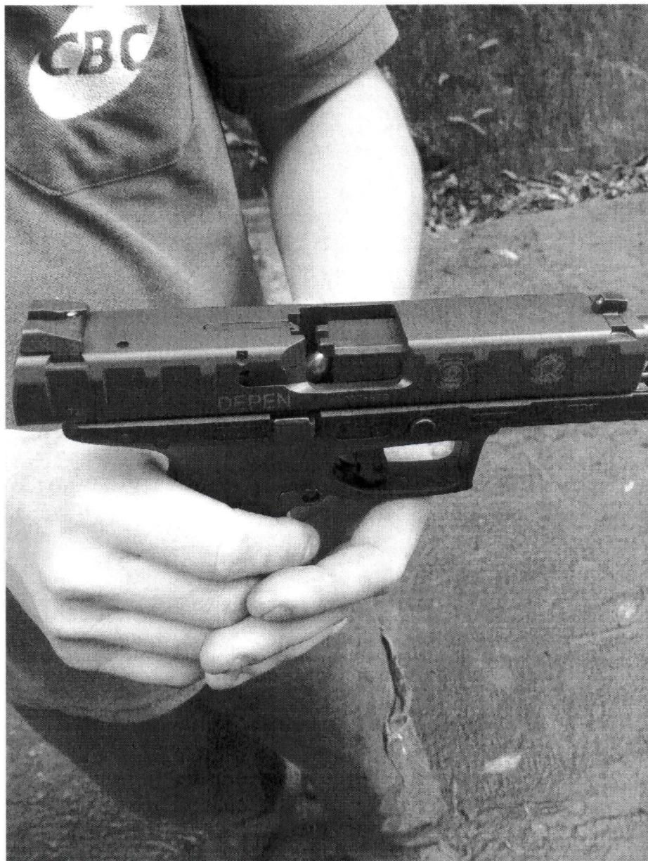
Imagem 4 – Exemplo falha de alimentação (9mm NTA 124gr carregado no limite mínimo)
