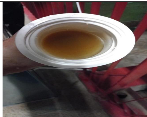
JB 1458 Td G Vários Hidr - Bebedouros saindo água com barro - Foto A3
