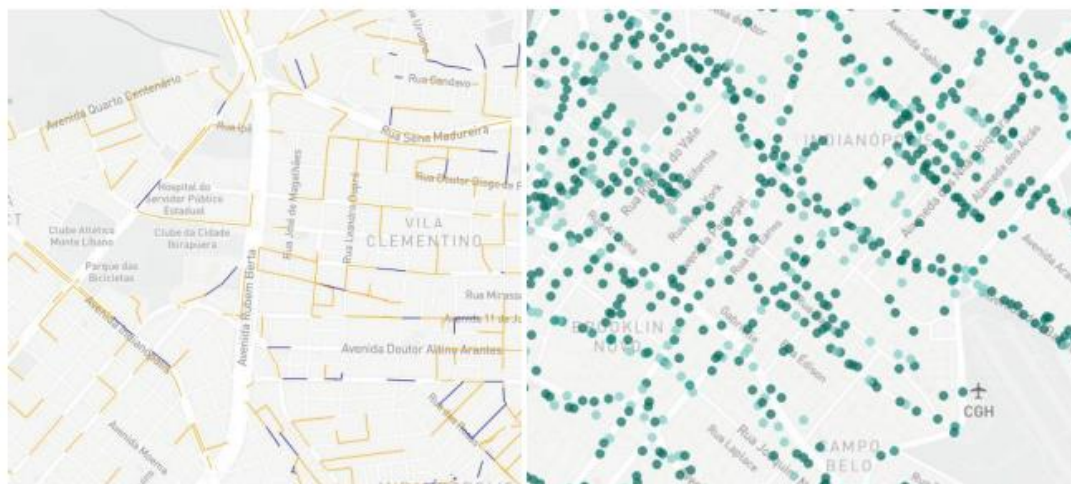
Figura 5. Mapa de galerias (esquerda, laranja original e azul derivada) e de bocas de lobo, bocas de leão e poços de visita (direita)
