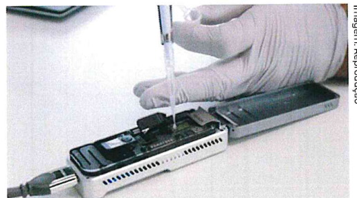
Sequenciador MinION™ de terceira geração
