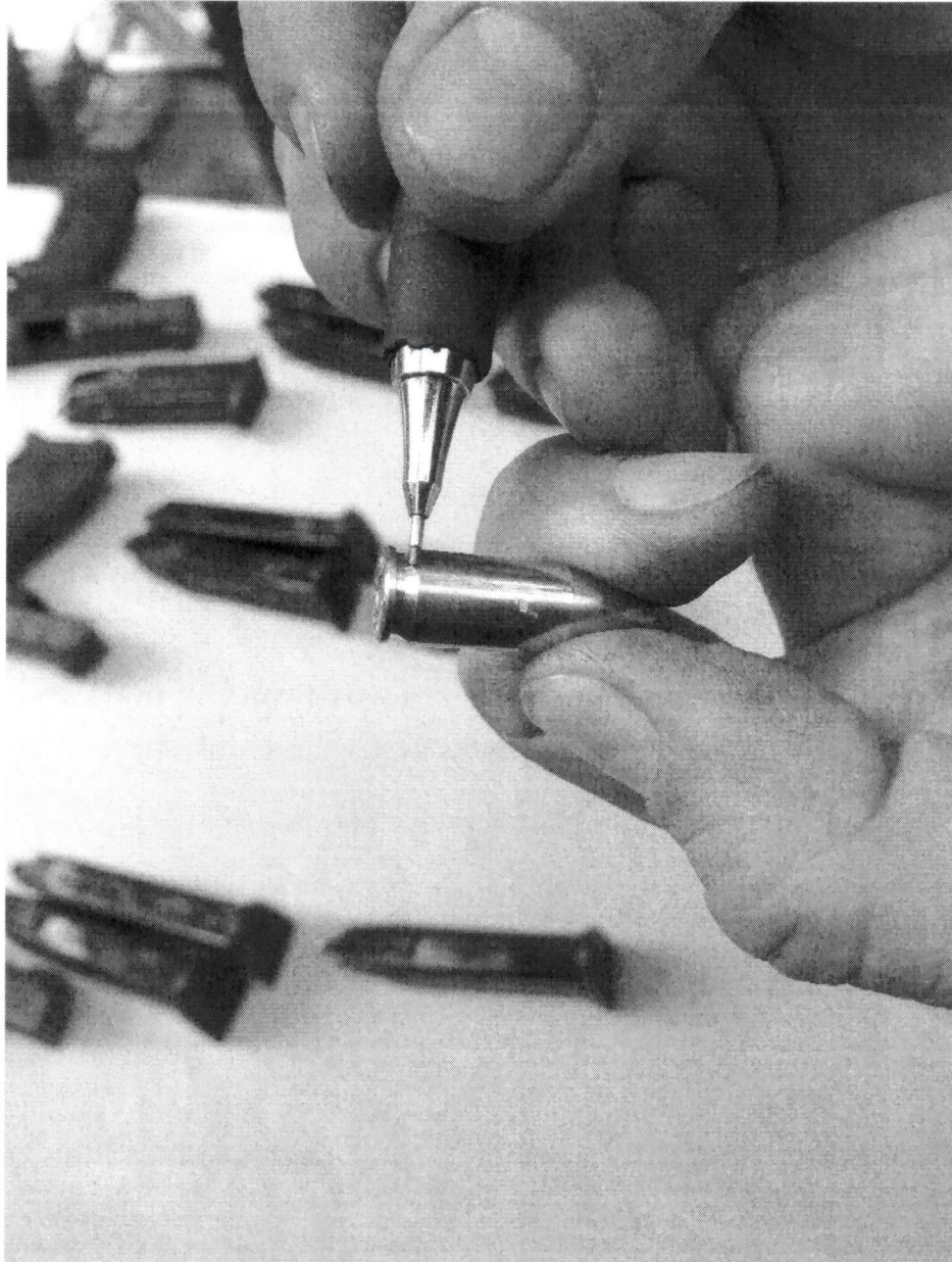
Imagem 5 – Marca do ferrolho no cartucho após a falha de alimentação (9mm NTA 124gr carregado no limite mínimo).
