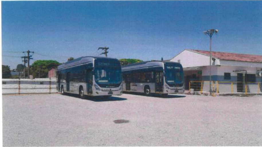
Ônibus elétrico a baterias com chassi BYD D9W e carroceria CAIO Millennium IV que compõem a Frota Piloto
