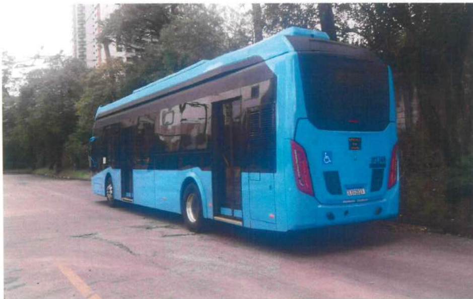
Ônibus elétrico a baterias com chassi eO500U de fabricação MBB – Passou em todos os testes de desempenho técnico especificados pela SPTrans
