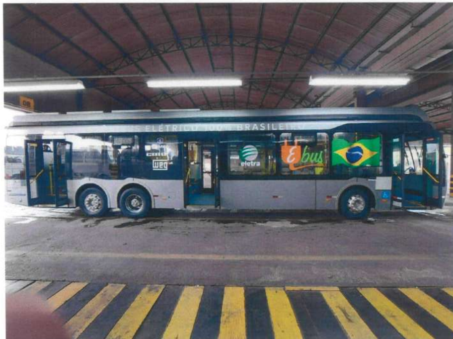
Ônibus Eletra de 15 metros – Passou pelos testes de desempenho técnico especificados pela SPTrans
