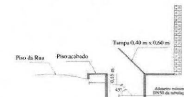
Figura 1 – Dispositivo de recalque no passeio público
