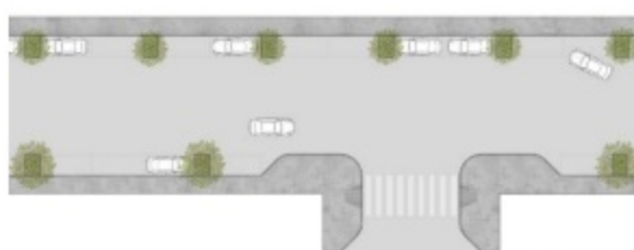
Figura 116 - Implantação de vaga verde nos dois lados da via.
