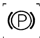
Figura 1 Freio de estacionamento Lâmpada piloto: Cor vermelha - Uso facultativo Ref. ISO 2575 nº 4.32
