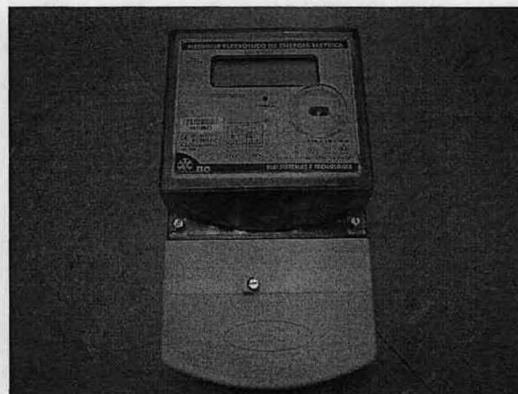
Medidor com PLC
